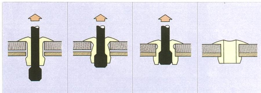
相手材の穴へリベットをさし込む。挿入しやすい様にリベット先がテーパになっています。
